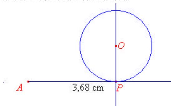
Si costruisce una semiretta di origine *A*, e su di essa un punto *P*; si misura la distanza di *P* da *A*. Poi si costruisce la retta per *P* perpendicolare alla semiretta *AP*, su di essa un punto *O* e la circonferenza di centro *O* e raggio *OP*. Ora si usa *Trasporto di misura*: si costruisce sulla circonferenza il punto *Q* tale che l'arco *AQ* abbia lunghezza pari a quella del segmento *AP*.
