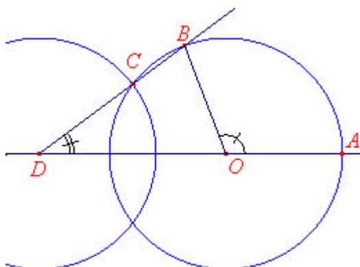
Si dimostra facilmente che l'angolo  $ODC$  è un terzo dell'angolo  $OAB$ .
