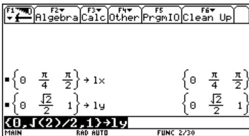
Costruiamo ora la matrice dei coefficienti. Il comando *seq*, del tutto analogo al *vector* di DERIVE, consente di costruire, per righe, la matrice delle successive potenze delle ascisse. La matrice dei coefficienti è la *trasposta* di quest'ultima.
