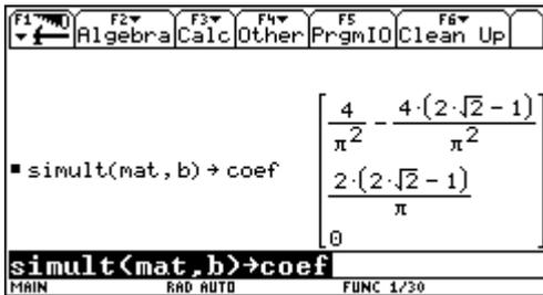
Trasformiamo i coefficienti in lista e calcoliamo infine il polinomio  $p(x)$  mediante il comando *polyeval*:
