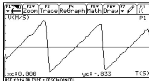
È evidente l'impulso rapidissimo del rimbalzo: la velocità passa da positiva a negativa, e cresce linearmente (si avvicina e poi si allontana dal sonar) tra un rimbalzo e l'altro. È possibile ora approssimare l'accelerazione di gravità dalla variazione di velocità tra un rimbalzo e il successivo: con la funzione TRACE seguiamo la curva della velocità tra un rimbalzo e il successivo, e registriamo tempo (xc) e velocità (yc).
