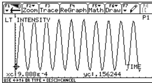
Se misuriamo la frequenza di quest'onda otteniamo quasi esattamente 100 Hz: a far variare l'intensità luminosa (non percepibile dal nostro occhio) è la corrente alternata a 50 Hz della rete. Un'oscillazione completa della tensione produce due oscillazioni complete dell'energia erogata (l'intensità luminosa non "sente" il verso della corrente).
