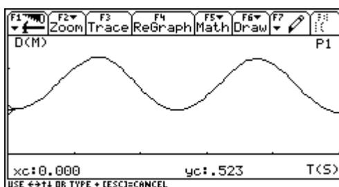
Il programma, sulla base dei dati, calcola la velocità "istantanea" del moto all'istante  $t_n$  sfruttando la posizione agli istanti  $t_{n-1}$  e  $t_{n+1}$ :
