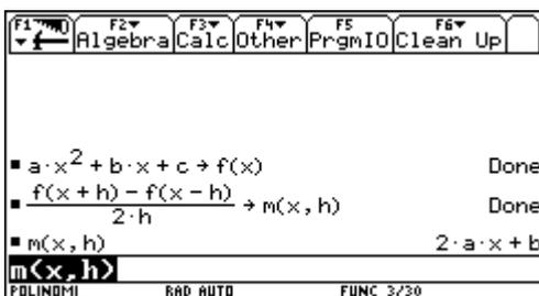
Come si vede, il rapporto incrementale simmetrico applicato ad una generica funzione quadratica è indipendente da  $h$ , e fornisce direttamente la derivata della funzione. L'interpretazione fisica è evidente: in un moto uniformemente accelerato la velocità media in un intervallo di tempo  $[t_1, t_2]$  è uguale alla velocità istantanea nell'istante  $\frac{t_1 + t_2}{2}$ .
