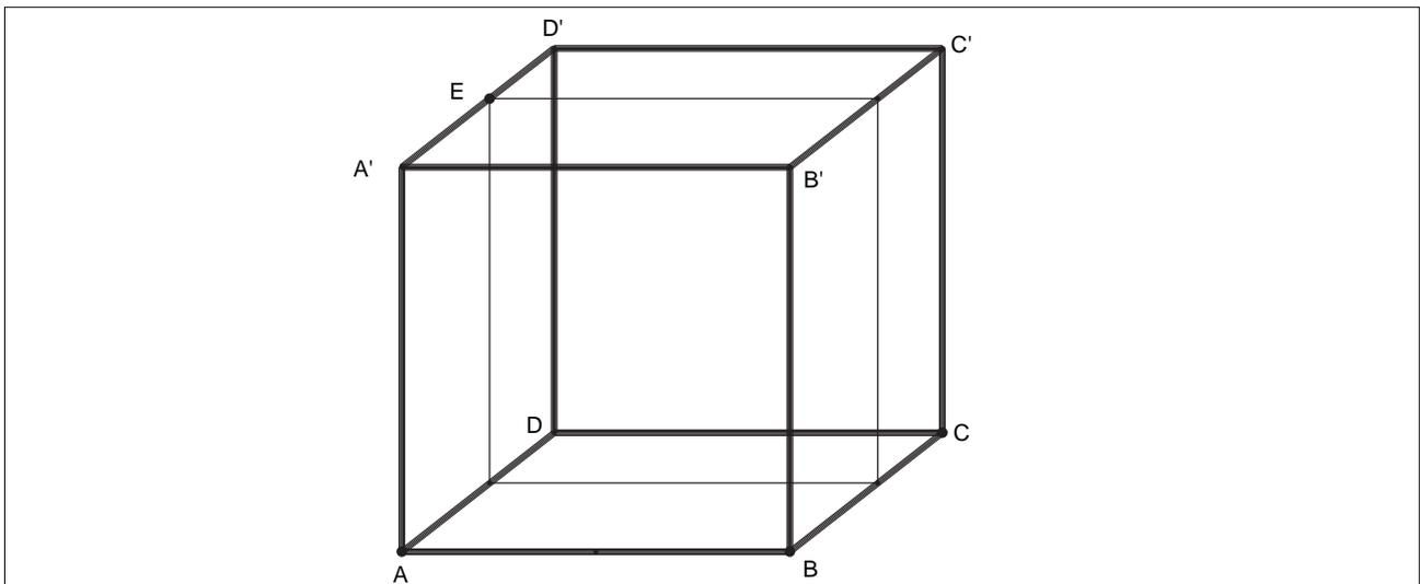
Figura 2.9 Sezione ottenuta (quadrato) con un piano parallelo ad una faccia.
