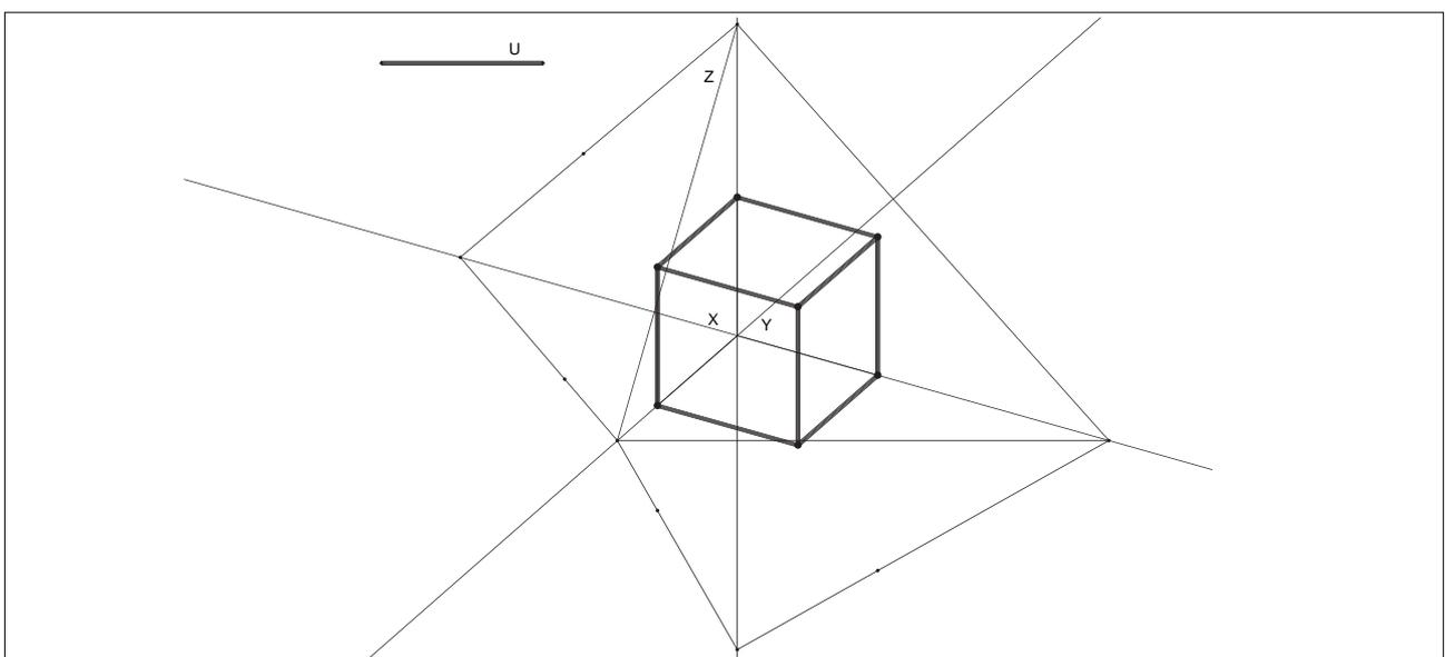
**Figura 3.4** Cubo in assonometria ortogonale trimetrica
