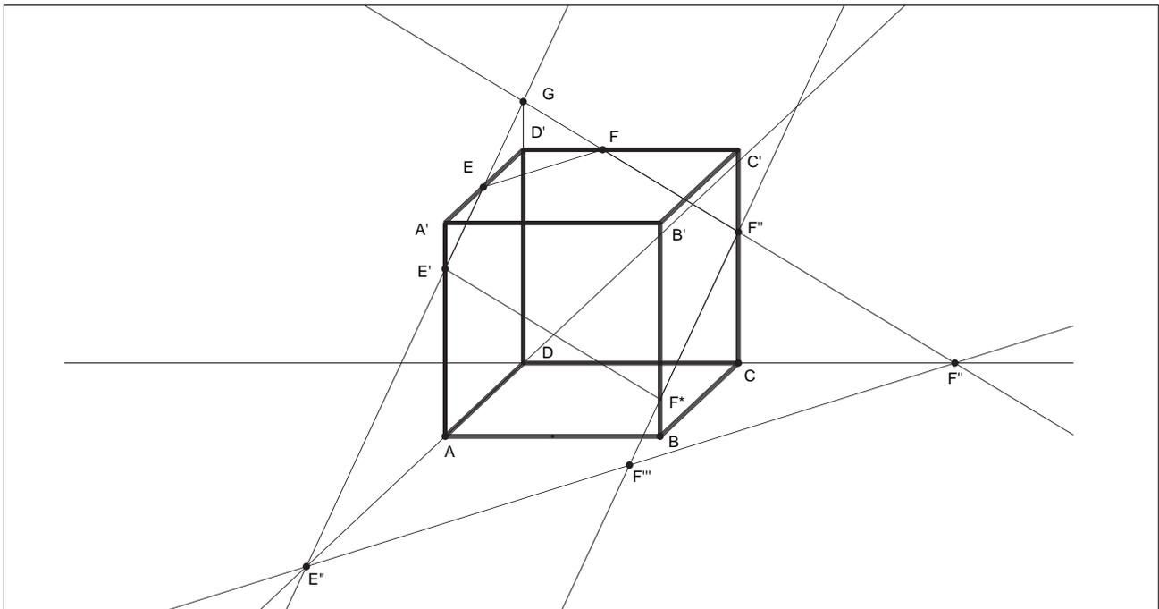
Figura 2.2 Sezione pentagonale del cubo (il piano interseca AA', BB', CC').
