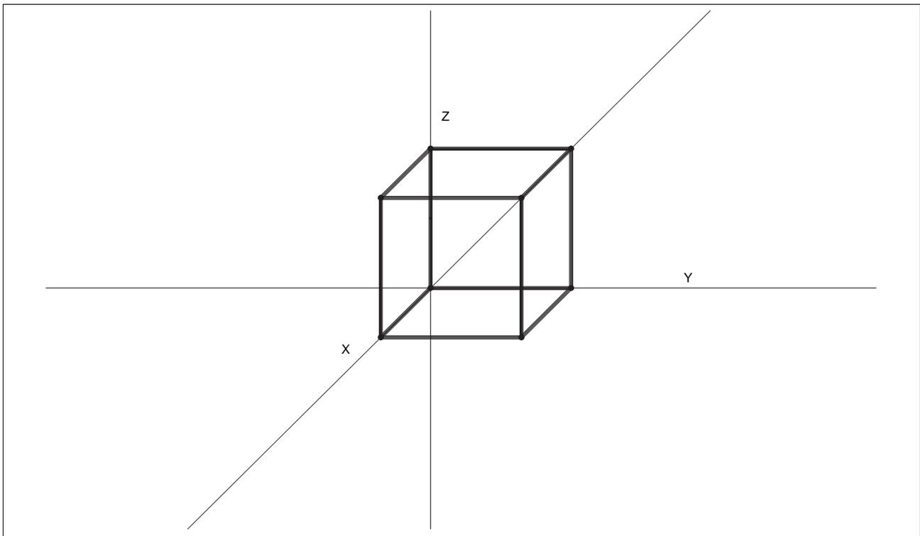
*Figura 3.6 Cubo in assonometria obliqua cavaliera rapida*
