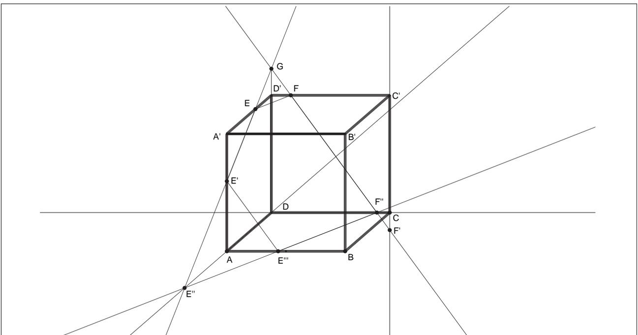
**Figura 2.4** Sezione pentagonale del cubo (il piano interseca  $AA', AB, CD$ ).
