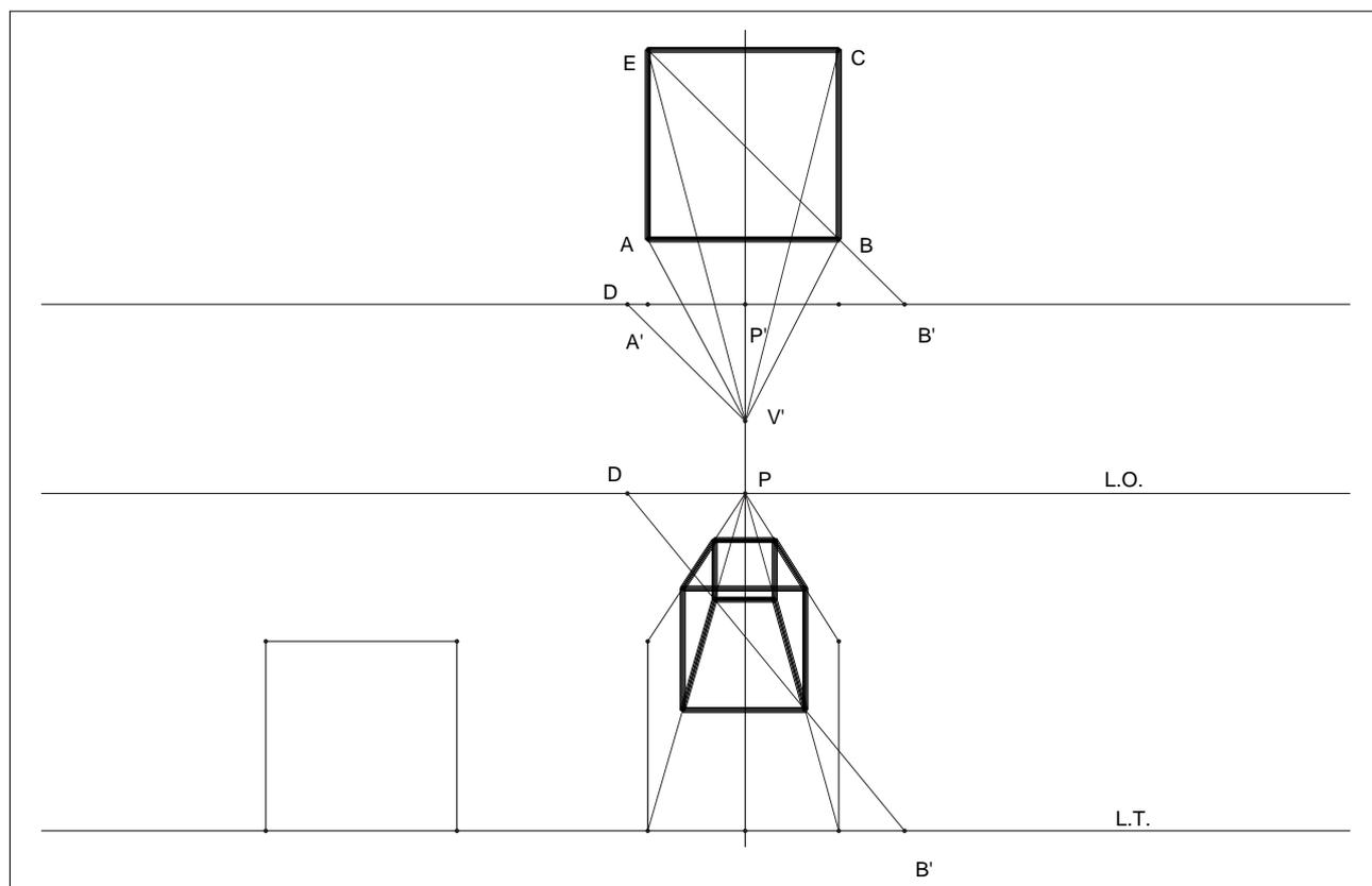
*Figura 3.8 Cubo in proiezione centrale o in prospettiva.*
