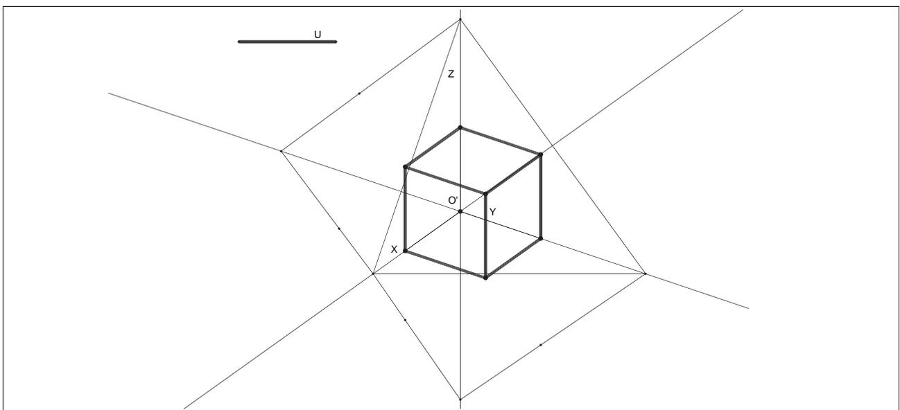
**Figura 3.3** Cubo in assonometria ortogonale dimetrica
