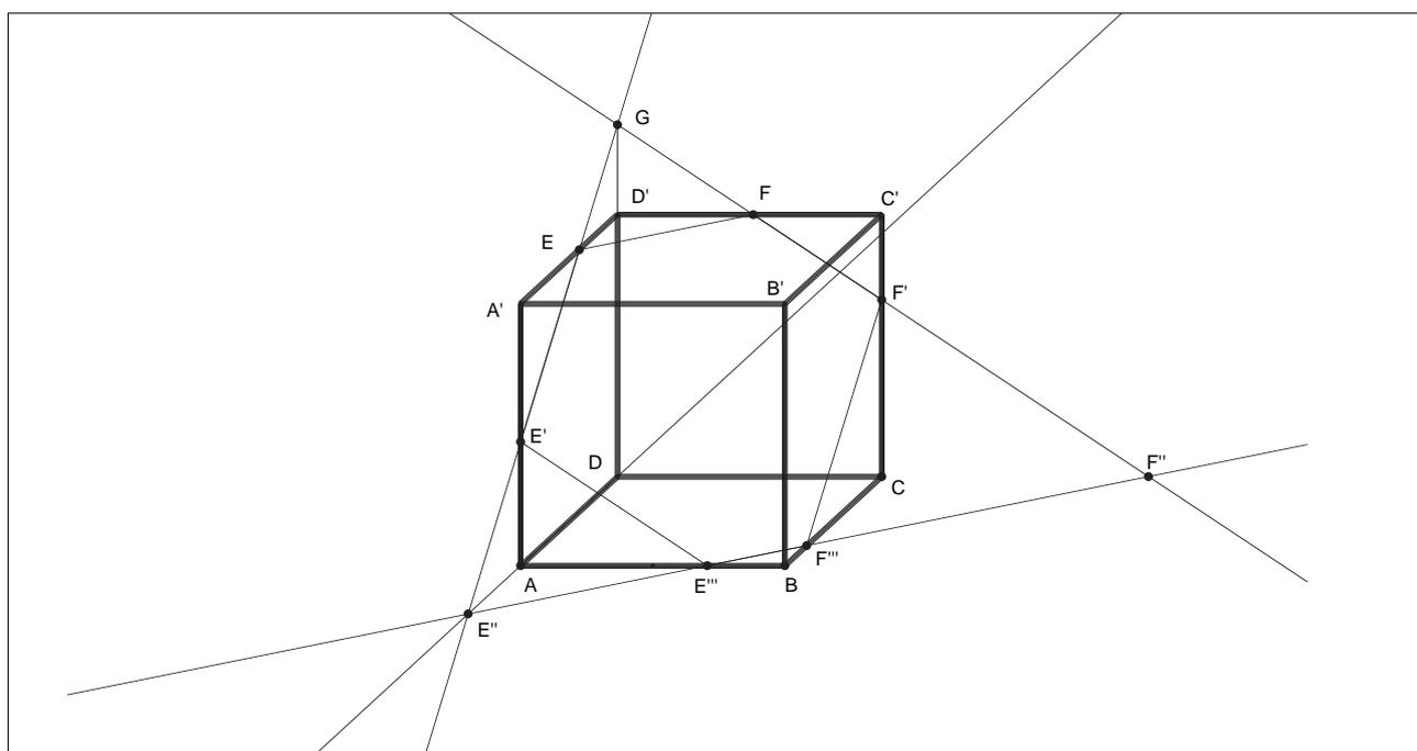
**Figura 2.1** Sezione esagonale del cubo (il piano interseca AA', CC', AB e BC).
