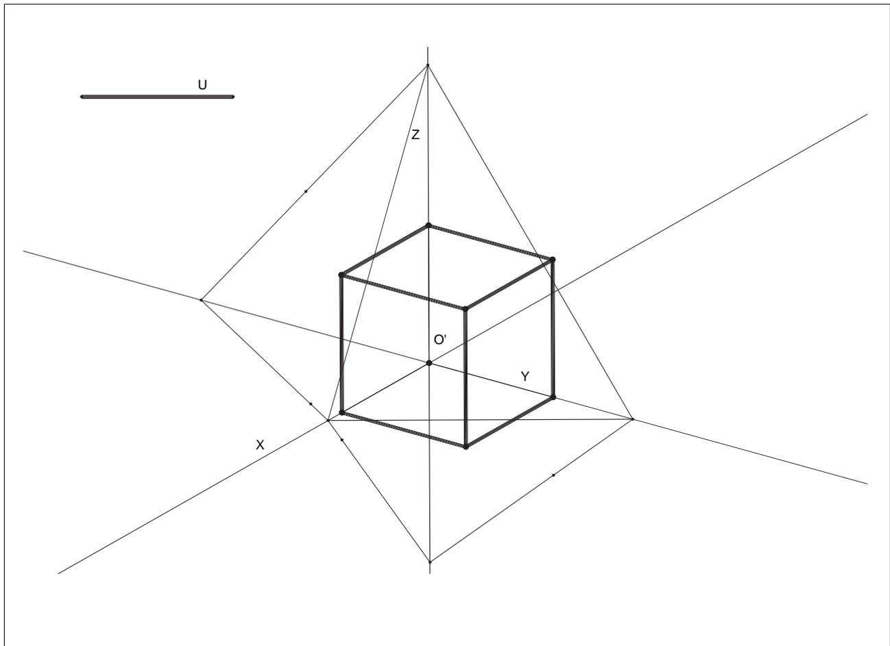
*Figura 3.1 Costruzione del rapporto di riduzione con l'assonometria ortogonale*
