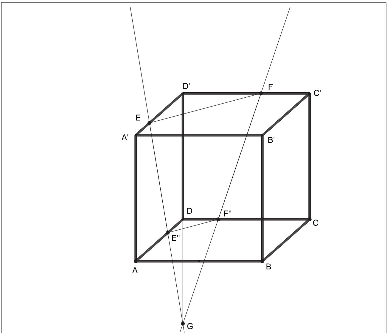
*Figura 2.7 Sezione quadrangolare (trapezio) del cubo (il piano interseca AD, DC).*
