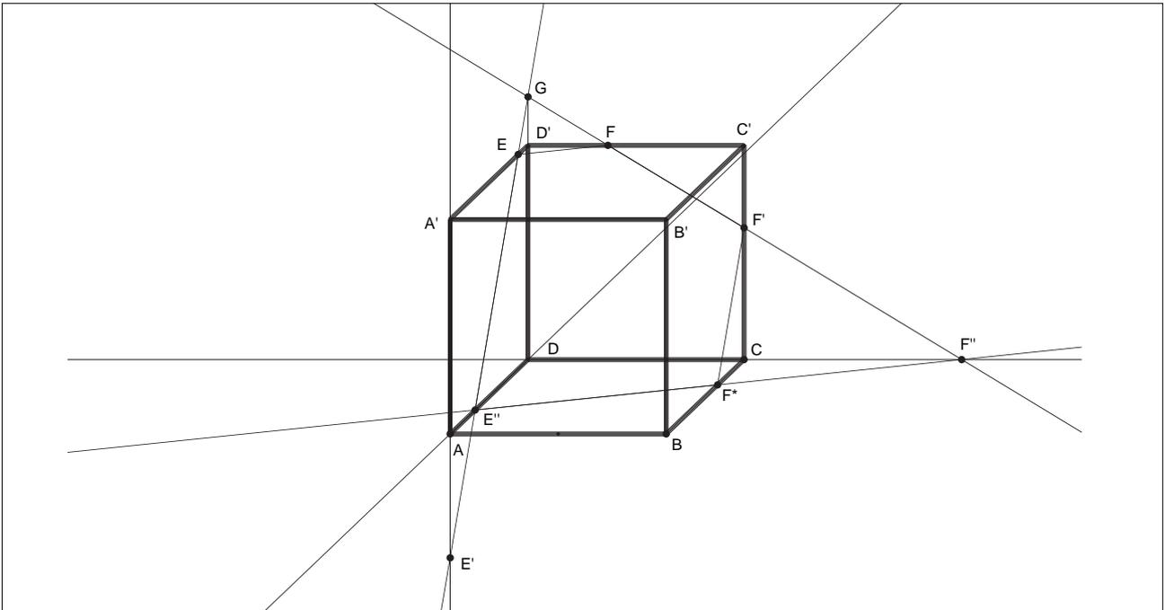
**Figura 2.3** Sezione pentagonale del cubo (il piano interseca  $AD, BC, CC'$ ).
