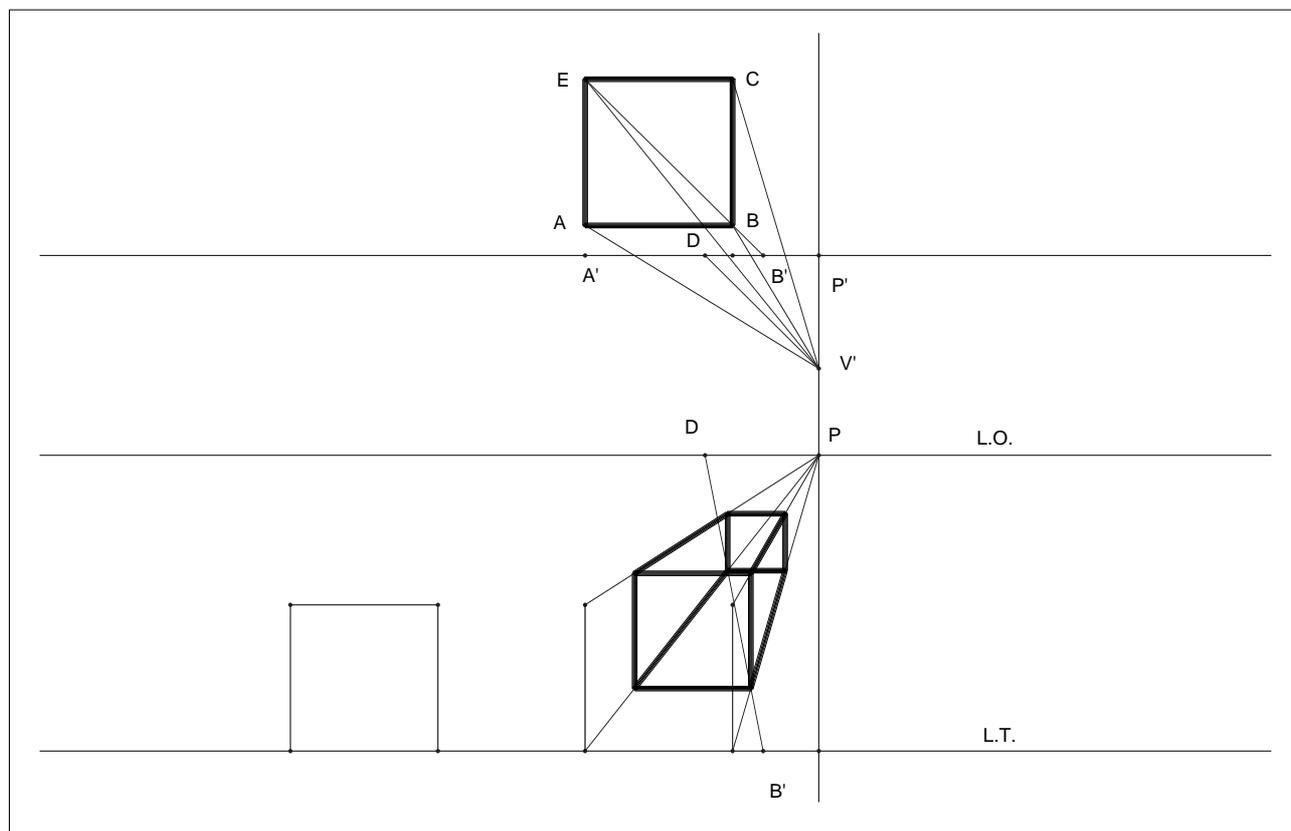
*Figura 3.9 Cubo in proiezione centrale o in prospettiva.*
