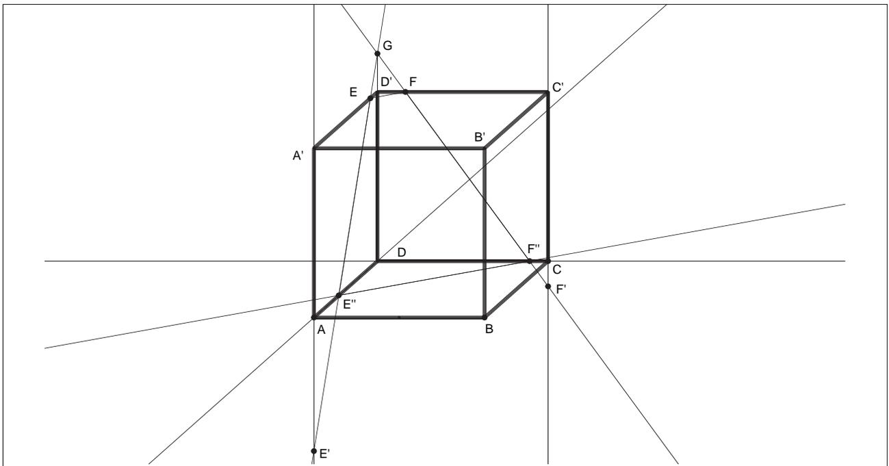
**Figura 2.5** Sezione quadrangolare (trapezio) del cubo (il piano interseca  $AD, DC$ ).
