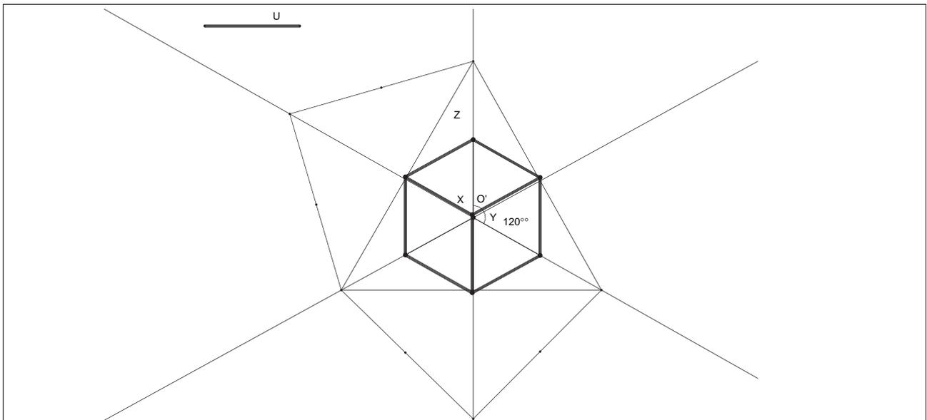
**Figura 3.2** Cubo in assonometria ortogonale isometrica
