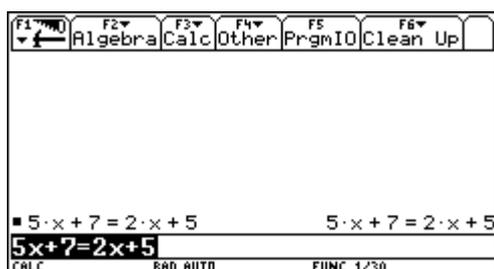
A differenza di Derive l'ambiente *Home* della TI-92 distingue tra *input* (che compare a sinistra del visore) e *output* (che compare semplificato a destra: la TI-92 non prevede il comando *simplify*).
