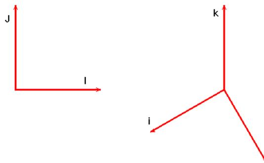
Un'altra assonometria utilizzata, soprattutto in Disegno, è l'assonometria "isometrica". Nell'assonometria isometrica **i** è ruotato di un angolo  $-150^\circ$  rispetto a **I**; **j** è ruotato di  $-60^\circ$  rispetto a **I**; il vettore **k** coincide con **J**. Le lunghezze dei vettori sono uguali.
