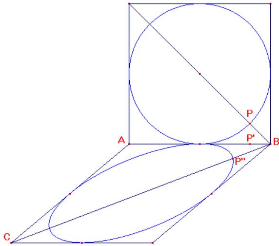
La conica per i quattro punti medi dei lati del parallelogrammo e per  $P''$  è l'ellisse cercata. Ora è possibile definire una **macro** (cioè una funzione memorizzata da Cabri) che prende in ingresso due vettori  $\underline{AB}$  e  $\underline{AC}$  e fornisce in uscita l'ellisse inscritta nel parallelogrammo definito dai vettori  $\underline{AB}$  e  $\underline{AC}$ .
