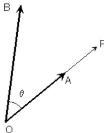
Possiamo quindi identificare un numero complesso di modulo  $\rho$  e argomento  $\theta$  con un operatore che ad ogni vettore  $\overline{OA}$  del piano associa il vettore  $\overline{OB}$  ottenuto nel modo detto. Un numero complesso  $z$  è dunque un operatore nel piano complesso che ad ogni vettore  $\overline{OA}$  fa corrispondere un vettore  $\overline{OB}$ :
