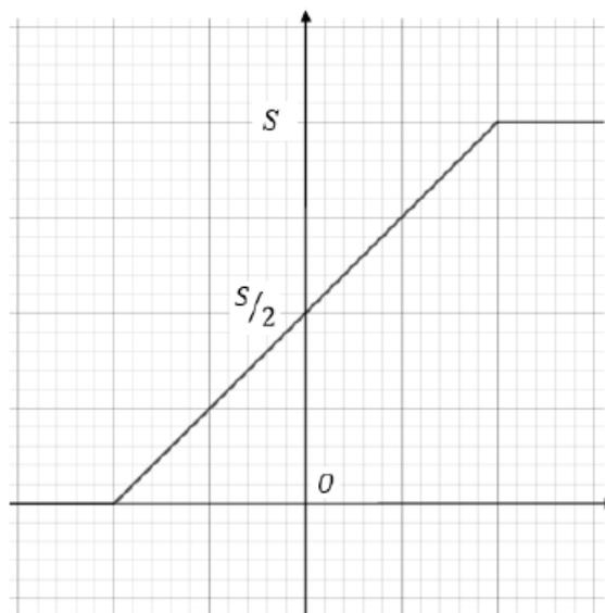
Il valore di  $g_k(x)$  passa da 0 a  $S$  con una rampa lineare, di pendenza pari alla pendenza di  $\Gamma_k$  nel punto di ascissa 0.
